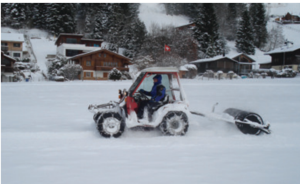
Walze für die Präparierung der Skating-Loipe. Wird bei geringer Schneehöhe eingesetzt
