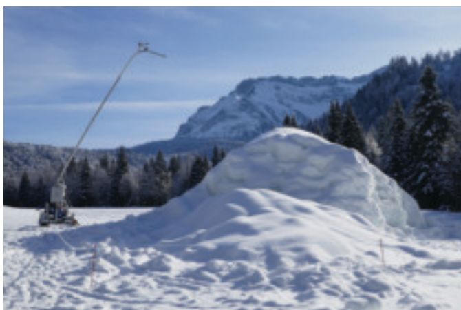
Schneelanze für die Erzeugung von technischem Schnee, Inbetriebnahme am 21.11.2019
